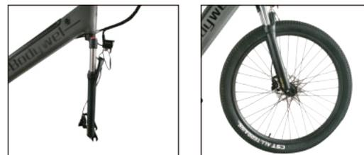
5.4.3 Inserte el eje de liberación rápida en el muelle y apriete el tornillo (la tuerca de liberación rápida debe estar en el mismo extremo que el freno).
